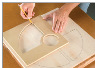
Dibuje la forma en el molde
