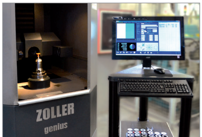
El sistema de medida CMT es completamente automático.
