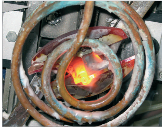
680° en pocos segundos y la solda esta terminada.
